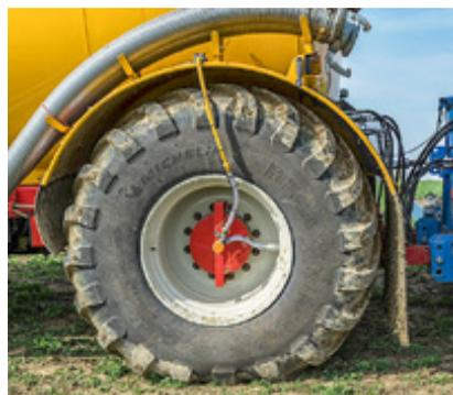
△ Reifendruckregelanlagen verhindern tiefe Druckwiebeln im Boden.
