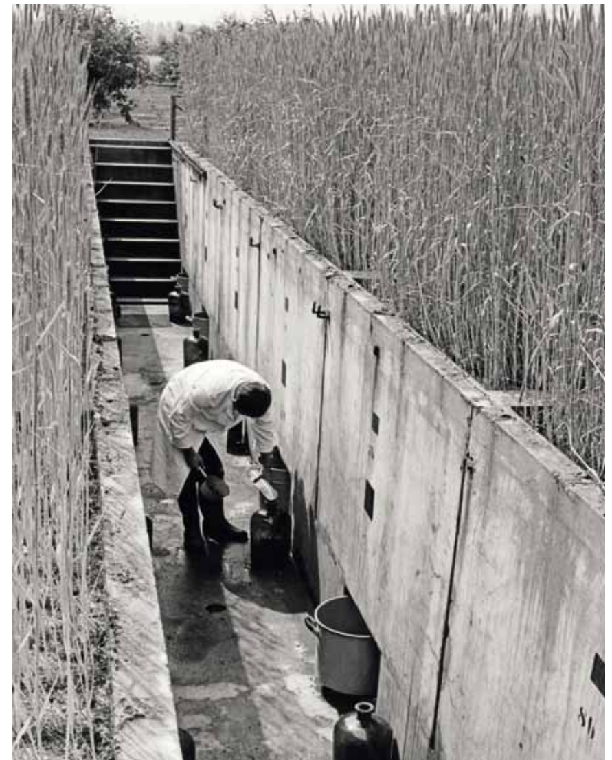
In der Lysimeteranlage wurde das Sickerwasser in Gefäßen aufgefangen und anschließend analysiert
